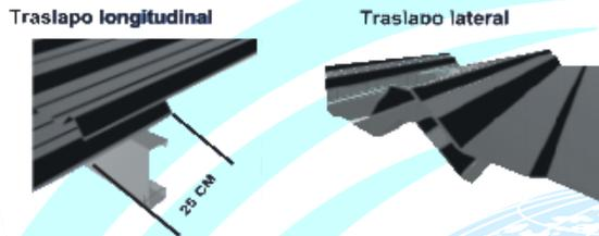
✓ La teja *Súper Industrial* viene diseñada en unos de sus extremos longitudinales una cresta mas alta que la otra, con el fin que esta quede en la parte superior y la baja en la parte inferior al momento de realizar el traslapo longitudinal
